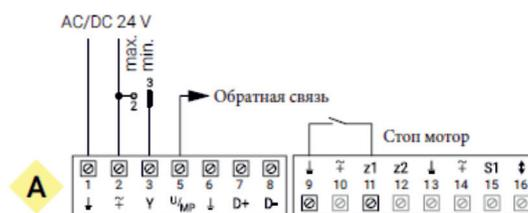
Дверной переключатель VRU-M1R может быть оснащен командой «Стоп мотор» для предотвращения перемещения привода заслонки в конечное положение при открытии двери.
