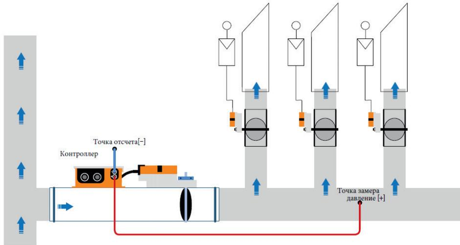
Контроль давления в воздуховоде с помощью VRU-D3-BAC (чистый воздух) и VRU-M1-BAC (загрязненный воздух).
